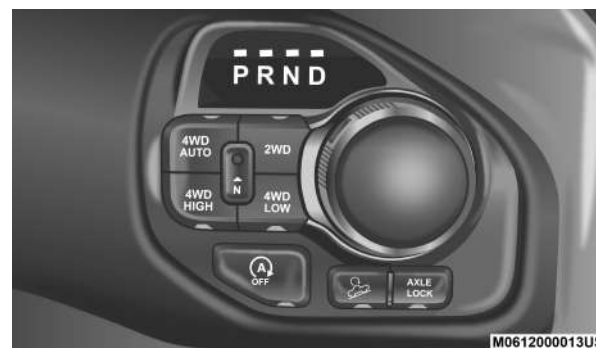
Caja de transferencia de cinco posiciones/a solicitud — Solo transmisión de ocho velocidades
