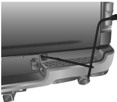
Insertión de los tubos de extensión en el orificio de acceso
