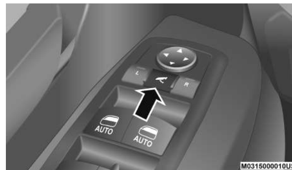
Interruptor del espejo plegable eléctrico
