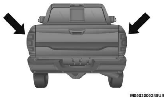
Ubicaciones de los sensores de radar
