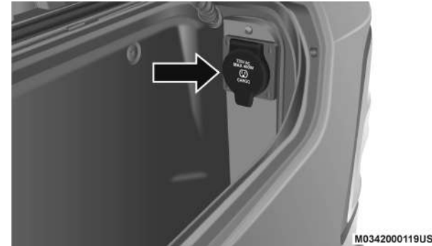
Inversor de corriente de la Ram Box
