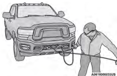
Tirar del cable sintético con tensión
