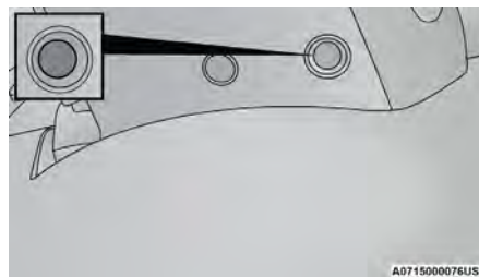
Puerto de acceso de anulación del selector de marchas
