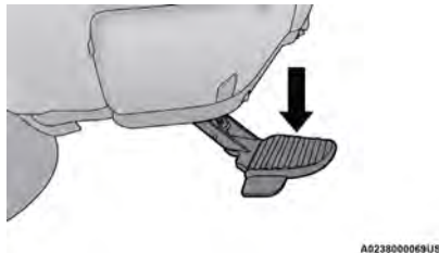
Peldaño de la plataforma (extendido)
