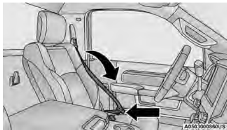
Extracción de la placa de cierre
