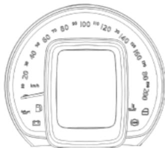
El kilometraje total y parcial se pueden visualizar en la pantalla. El kilometraje parcial se visualiza a través de la función **TRIP**, situada en la extremidad de la palanca derecha o, según la versión, a través del menú del ordenador de a bordo.
