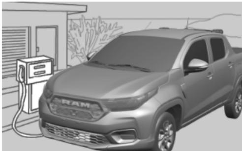
Para garantizar el reaprovisionamiento completo del depósito, efectuar dos operaciones automáticas (desarme) del surtidor de aprovisionamiento sin quitar el surtidor de la boca de llenado. Consultar la legislación vigente.
