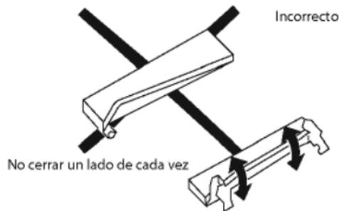
Encajar el plástico cosido en la lateral de la lona en el perfil, haciendo una palanca de tensión **I**, empezando el encaje por las extremidades **J** y finalizando por la región central **K**.
