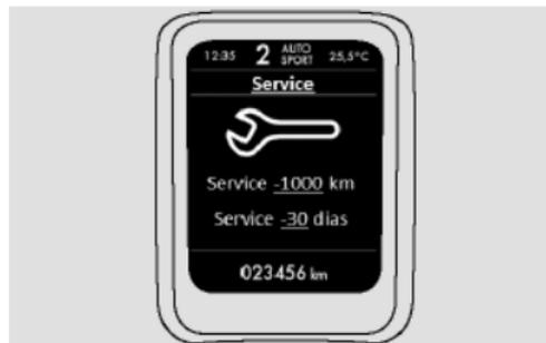
en el “Plan de mantenimiento programado”, la puesta a cero (reset) de los contadores de tiempo o kilómetros para el próximo mantenimiento programado.
