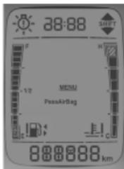
Esta función permite activar o desactivar el airbag del lado del pasajero a través de los botones ▲ y ▼ en el conjunto de botones ubicado en la parte superior del tablero.
