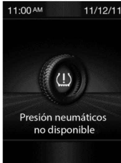
Si el sistema detectar que uno o más neumáticos están con presión inferior a la condición inicial de monitoreo del sistema (realizada tras la calibración y puesta a cero), deberá indicar a través de un pop-up en la pantalla seguido por el encendido del testigo
