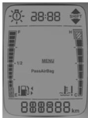
Esta función permite activar o desactivar el airbag frontal del lado del pasajero a través de los botones ▲ y ▼ en el conjunto de botones ubicado en la parte superior del tablero
