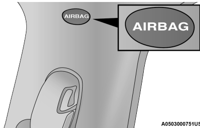
Ubicación de la etiqueta de la cortina inflable del airbag lateral suplementario (SABIC)
