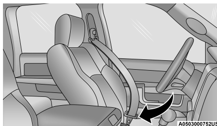
Inserción de la placa de cierre en la hebilla
