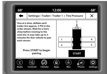
Emparejamiento de la presión de los neumáticos del remolque
